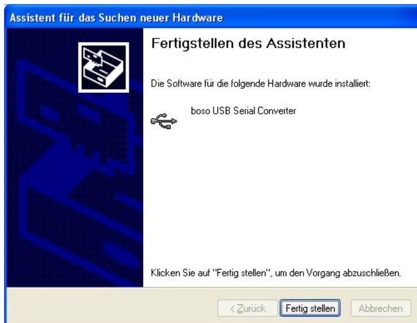
Da der Treiber sowohl die Installation als direkten USB-Anschluss als auch als virtuellen COM-Anschluss beinhaltet, sind die oben beschriebenen Schritte erneut durchzuführen.
