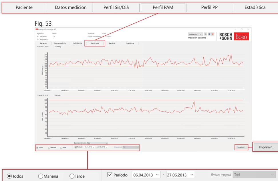
Aquí se muestra en el diagrama superior la evolución de la presión arterial media calculada ( $PAM = \text{diástole DIÁ} + 1/3 \text{ presión del pulso PP}$ ).
